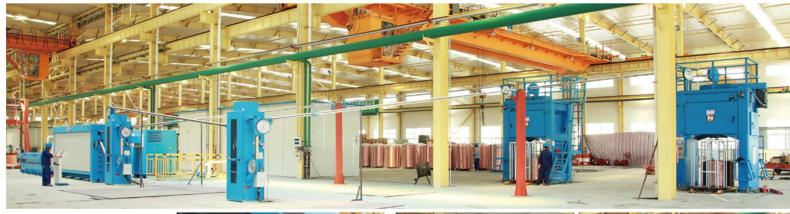
以美国南方线材公司SCR3000连铸连轧生产线生产的Φ8mm 低氧铜杆为原料,依托德国进口的尼霍夫拉丝机,专门生产为 客户量身定制,适合中小拉的软、硬铜线,规格可从Φ1.8mm 直至Φ4.5mm, 收线方式为梅花收线或紧密收线, 所生产的铜 线表面光亮、无毛刺、无氧化、抗变色能力强、性能各项指标 符合国家标准GB/T3953-2009。
